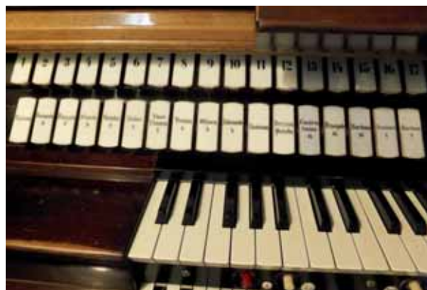
Figura 2. Placchette a bilico dei registri del Grand'Organo (colore bianco) e del Pedale (colore celeste) e relative placchette della combinazione libera (numerate)
